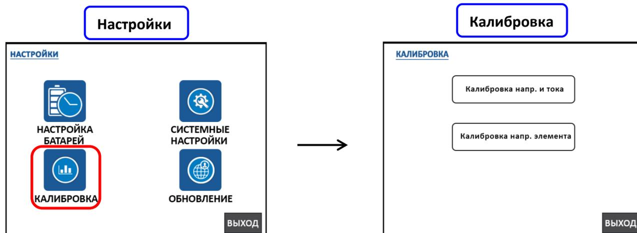
При калибровке тока, подключите токовые клещи на силовой провод с нагрузкой, замерьте эталонным прибором токи и установите фактическое значение, нажав на экране нужный канал токовых клещей для вызова меню ввода значения.
