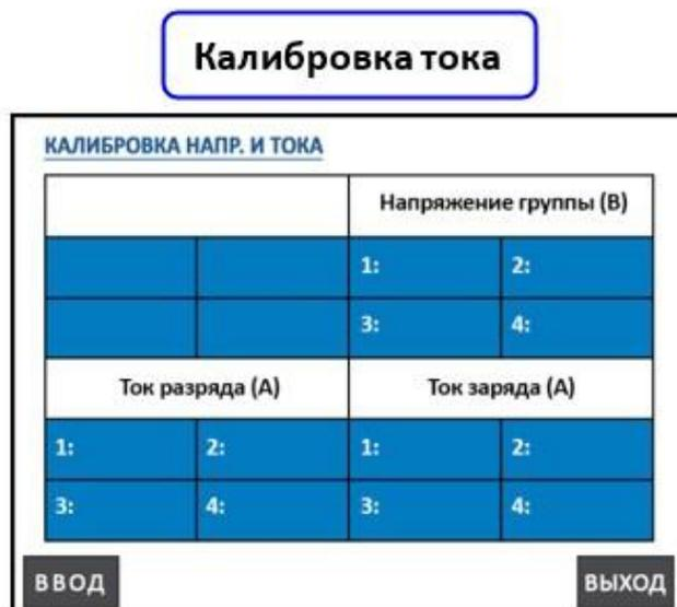
При калибровке напряжения на датчиках поэлементного контроля необходимо ввести номер калибруемого канала и фактическое значение напряжения на данном канале, путем нажатия на соответствующее окошко на сенсорном экране для вызова меню ввода значений.
