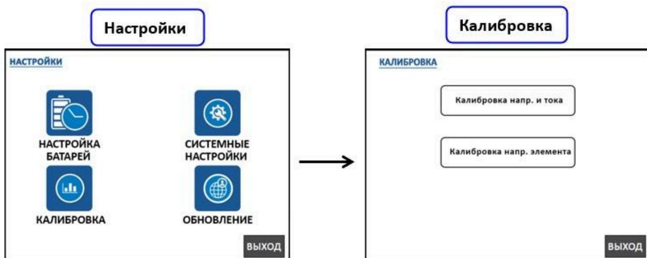
При калибровке тока, подключите токовые клещи на силовой провод с нагрузкой, замерьте эталонным прибором токи и установите фактическое значение, нажав на экране нужный канал токовых клещей для вызова меню ввода значения.
